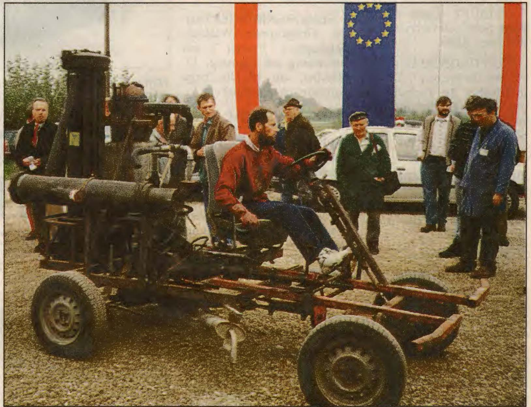
War bei der Ausstellung über nachwachsende Energie in Wippenham zu sehen: dieser Eigenbau-Prototyp eines Fahrzeuges mit Holzvergaser-Motor. Vielleicht die Technik der Zukunft?
